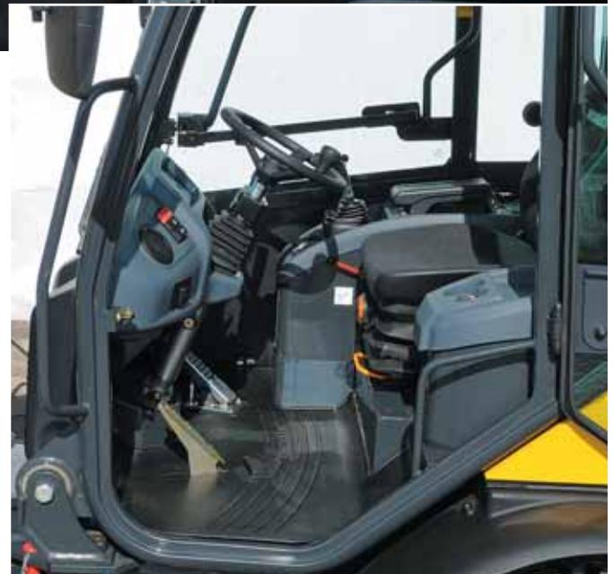
Usa larga a cabinei cu o singura treapta va ofera acces usor si rapid in interiorul si in afara cabinei. Izolarea fonica optima, butoanele functionale situate la indemana si ventilatoarele reglabile vin in completarea unui mediu de lucru confortabil.
