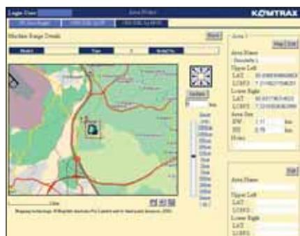
*Securitate totala – caracteristica "bloare motor" permite programarea momentului la care sa porneasca motorul utilajului. De asemenea, cu ajutorul caracteristicii "arie geografica", KOMTRAX™ trimite notificari ori de cate ori echipamentul dumneavostra se deplaseaza in cadrul sau in afara zonei de prestabilitate de dumneavostra.*
