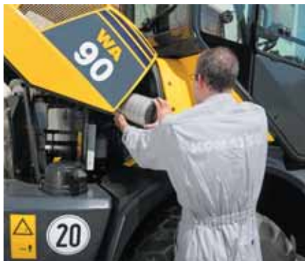
Acceso práctico a los filtros de aire
