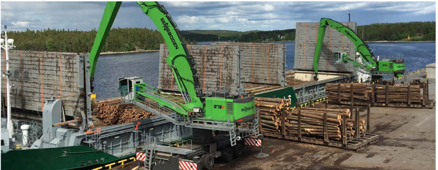
Rundholzverladung mit Holzgreifer, Schweden
