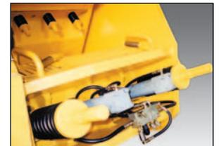
Cilindro de ajuste de la boca de salida
