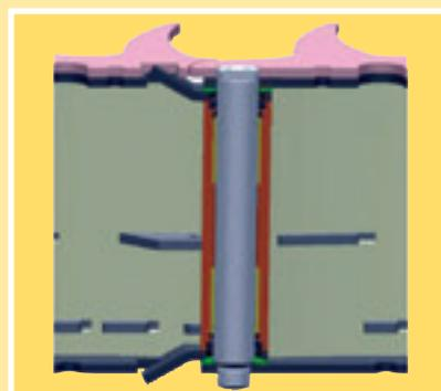
**Coupe tirée :** les tiges sont coupées par les couteaux étagés fixes et par les couteaux de coupe rotatifs avec une qualité similaire à celle des ciseaux. Les couteaux faciles à remplacer sont revêtus de carbure de tungstène et autoaiguïsés.
