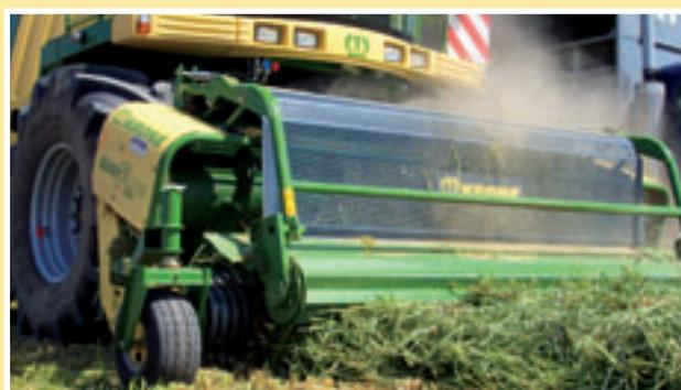
Entraînement hydraulique sur une plage de régime énorme. Réglage facile depuis le siège du conducteur **en continu entre 300 et 700 t/min**. Vous pouvez également choisir d'activer simplement la régulation automatique en fonction de la vitesse d'avancement et découvrir ce que la BiG X peut réaliser.
