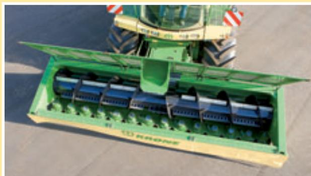
Qualité de coupe EasyCut : la barre de coupe directe XDisc a été conçue en se basant sur les faucheuses à disques EasyCut KRONE dont la réputation n'est plus à faire. La barre de coupe fermée et soudée garantit une stabilité maximale.
