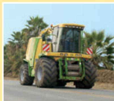
**Puissance double moteur** : la centrale sur la BiG X 800 est composée de deux moteurs, le premier de 510 CV, le deuxième de 316 CV. Lorsqu'ils passent tous les deux synchrones au travail, on a une puissance de 836 CV.
