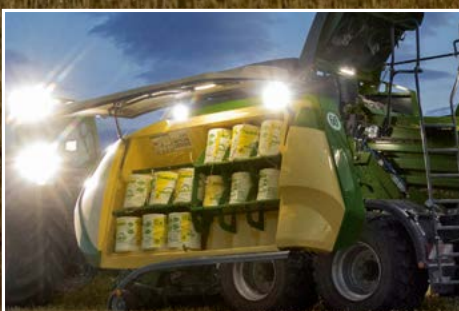
Beleuchtung in den Garnkästen
