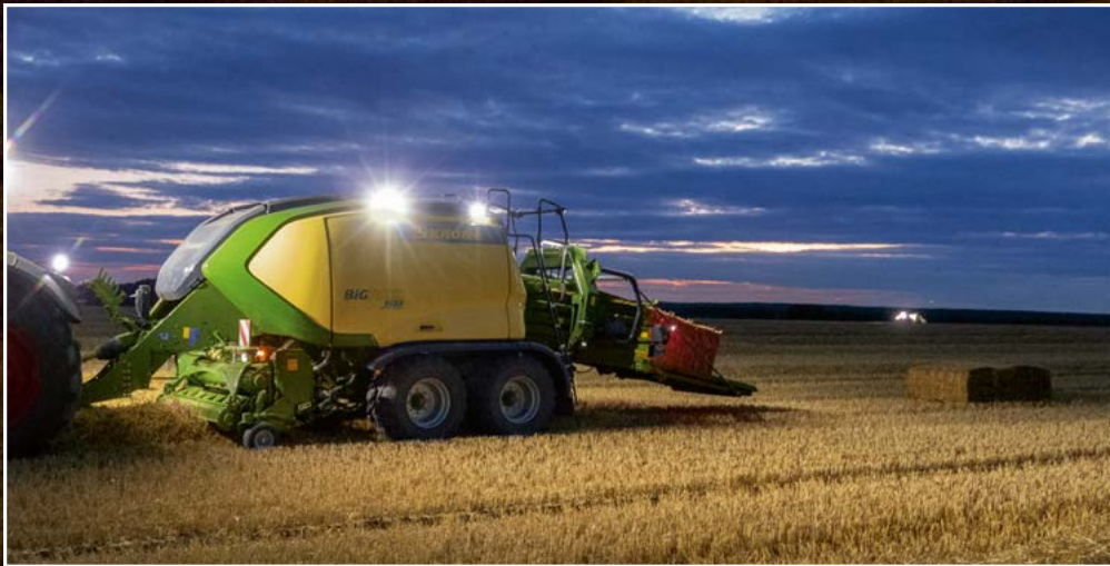
Arbeitsbeleuchtung auf den Garnkästen
