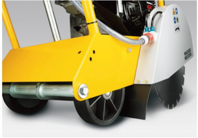
Los modelos de cortadoras de juntas a gasolina BFS 1345 y BFS 1350 ofrecen la opción de escoger entre una distancia entre ejes normal o corta. La versión corta permite un manejo aún más ligero de la cortadora de juntas.
