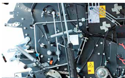
Circuits hydrauliques en tubes rigides en acier
