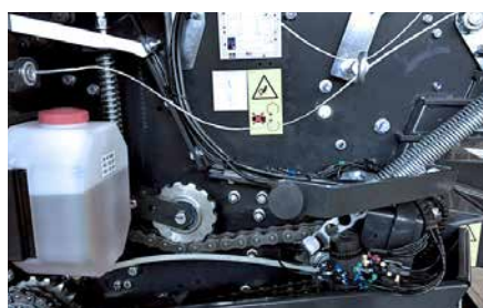
Lubrification automatique de la chaîne avec sorties réglables individuellement.
