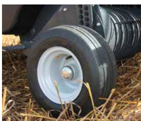
Roue de jauge avec réglage de la hauteur de ramassage.
