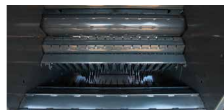
La chambre est dotée de 5 rouleaux à l'avant...
