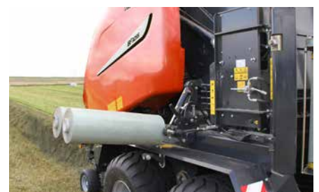
Réserve de film étirable à commande hydraulique pour un confort d'utilisation maximal.
