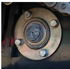
Chaque rouleau est monté sur des roulements robustes.
