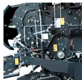
Circuits hydrauliques avec tubes rigides.
