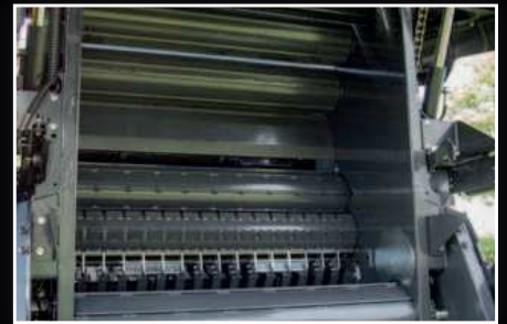
PowerMax Ballenkammer: 17 Heavy Duty Walzen für eine dichte Ballenproduktion.
