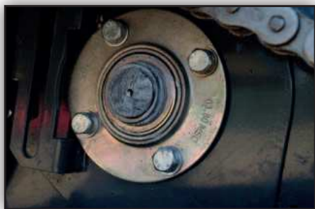
Jede Walze ist in Heavy Duty-Lagern montiert.
