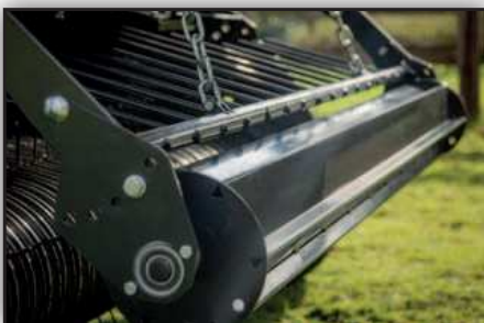
Der Rollenniederhalter sorgt für eine Vorverdichtung des Erntegutes und unterstützt den Materialfluss.
