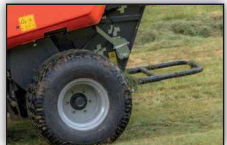
Die Ballenrollbahn lässt den Ballen weit nach hinten rollen, so dass ohne vorheriges Rückwärtsfahren die Heckklappe geschlossen werden kann.
