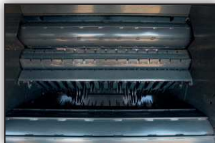
Das Ballenkammerkonzept enthält 5 Walzen im vorderen Bereich...
