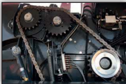
Eine Heavy Duty 1¼ Zoll Antriebskette sorgt für hohe Einsatzsicherheit und niedrige Wartungskosten.
