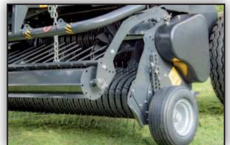
Die leicht in der Höhe verstellbaren Pickup-Tasträder sind luftbereift. Durch den innenliegenden Pickup-Antrieb müssen die Tasträder für die Straßenfahrt nicht demontiert werden.
