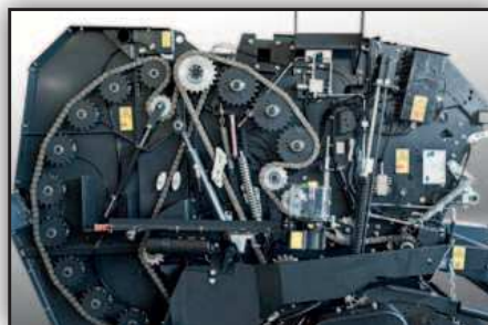
Eine Heavy Duty 1 1/4 Zoll Antriebskette sorgt für hohe Einsatzsicherheit und niedrige Wartungskosten.
