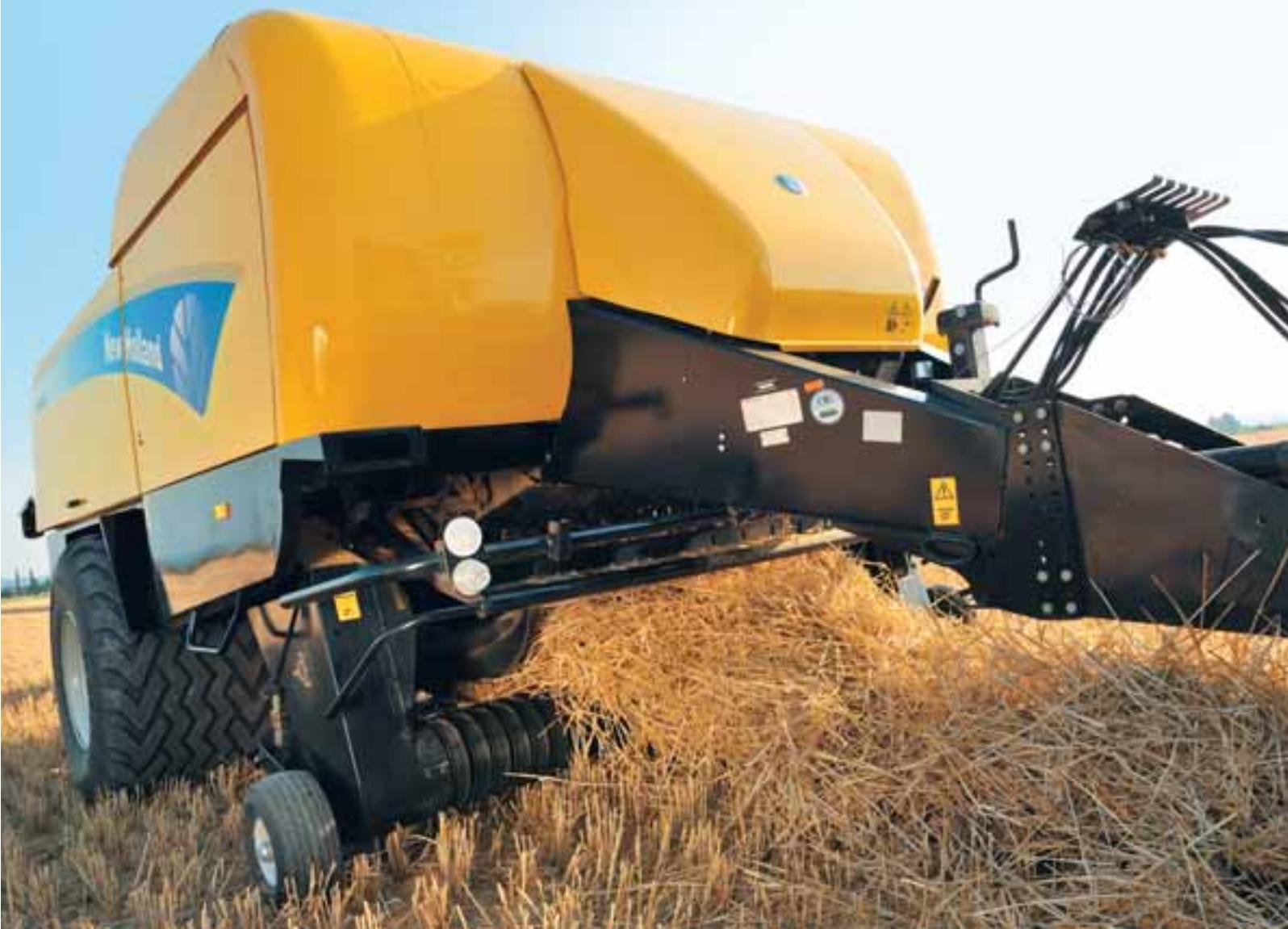
Il pick-up Super Sweep™ è in grado di raccogliere anche il più piccolo stelo di paglia o di fieno. Le caratteristiche collaudate del pick-up, come i denti ricurvi e la spaziatura ravvicinata dei denti, per non parlare dell'efficienza del pettine raccoglitore d'andana e delle ruote tastatrici pneumatiche, permettono di raccogliere perfettamente tutto il prodotto in campo a una velocità di lavoro elevata.
