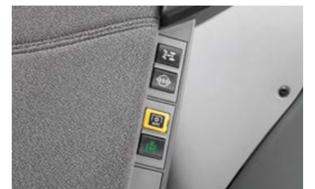
Aktivierung der Vorderachsfederung
