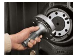
Einfacher Wechsel der Zapfwellenstummel
