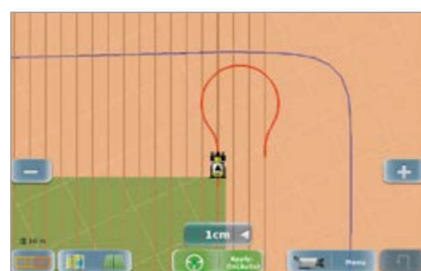
Mit AUTO TURN wendet der Traktor automatisch am Vorgewende.
