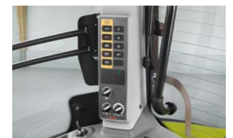
Zapfwellengeschwindigkeiten und elektronische Kraftheberregelung am B-Holm einstellbar
