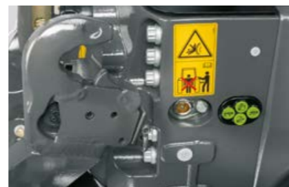
Externe Bedienung für den Frontkraftheber und ein Steuergerät
