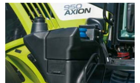
640-l-Kraftstofftank mit eingelassenem 56-l-Harnstoffvorrat
