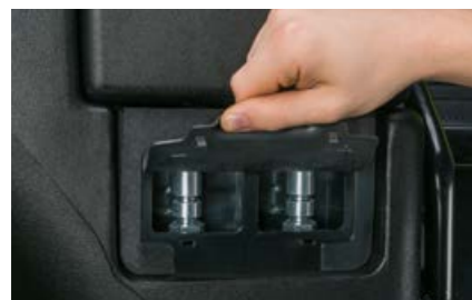
Externe Batteriepole sind direkt an der linken Einstiegsseite erreichbar.
