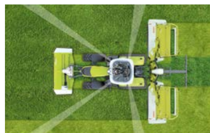
Durch die spezielle Anordnung der hinteren Kabinenpfosten und die gewölbte Heckscheibe ergibt sich für den Fahrer eine optimale Sicht auf das Arbeitsgerät und den Anbauraum.
