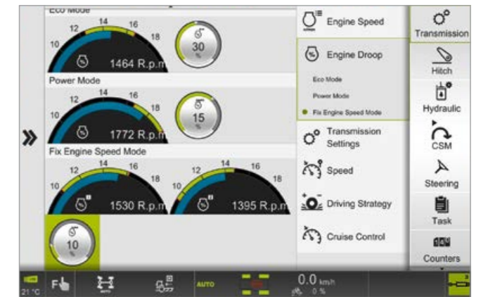
Einstellung der Motordrückung für „Eco“ und „Power“, sowie den Motordrehzahlspeicher
