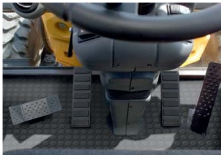
Schwenken mittels Fußpedal für ermüdungsfreies Arbeiten
