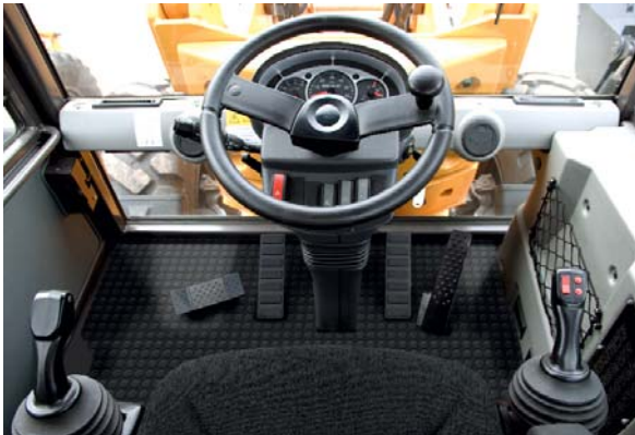
Einfache, intuitive Bedienung; alle wichtigen Arbeitsfunktionen sind im Joystick integriert
