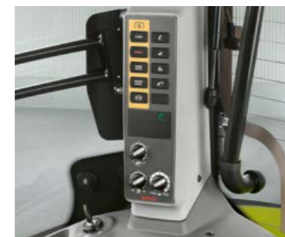
Présélection des régimes de prise de force et relevage arrière électronique installés sur le montant arrière droit de la cabine
