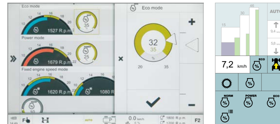
Réglage de la chute de régime moteur autorisée pour les modes « Eco » et « Power » ainsi que pour la mémoire de régime moteur
