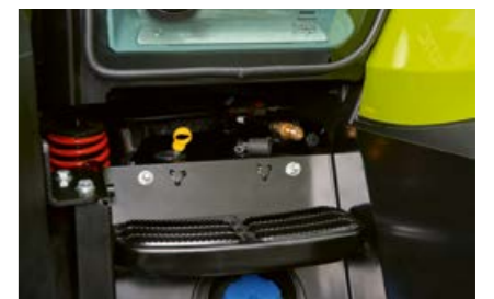
NOUVEAU : une prise d'air comprimé est présente au-dessus du marchepied d'accès à la cabine côté gauche.
