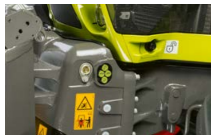
Commande extérieure du relevage avant et d'un distributeur (selon l'équipement)
