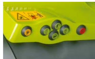
Commandes extérieures pour le relevage arrière, la prise de force et un distributeur au choix (CEBIS uniquement)
