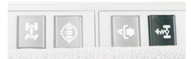
Activation de la suspension du pont avant
