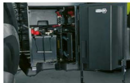
La batterie et la boîte à outils sont aisément accessibles à au niveau du marchepied droit.
