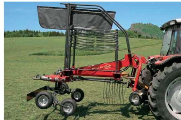
Per ridurre l'ingombro stradale in trasporto è possibile sganciare velocemente il braccio portadenti e fissarlo al telaio per mezzo di un apposito supporto.
