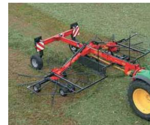
Andex 763 montato con assale tandem a 4 ruote e Terra Link Quattro (standard).
