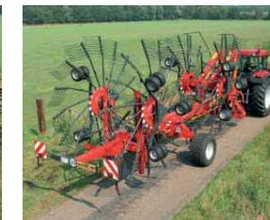
Con il suo esclusivo sistema di ripiegamento la macchina non supera i 4 m. di altezza evitando la rimozione delle braccia portadenti.
