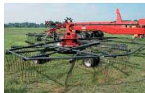
Ogni rotore può essere regolato in altezza indipendentemente, per mezzo di un sistema di controllo elettrico posto in cabina.
