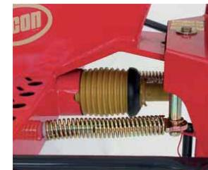
Una particolare testata d'attacco assicura un ottimo adattamento al terreno anche nelle manovre di fondo campo o in presenza di ostacoli. Due ammortizzatori d'oscillazione optional.
