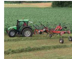
La possibilità di sterzare a 90° e la barra stabilizzatrice nella testata, assicurano grande manovrabilità a fondo campo e ottimo disimpegno durante le manovre.
