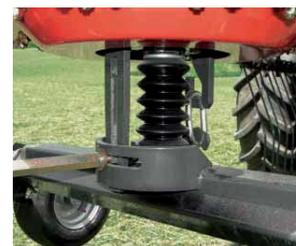
Regolazione infinitesimale della camme, per ottenere un'ottima formazione di andana in qualsiasi condizione.
