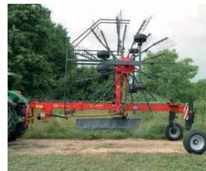
Ripiegamento idraulico dei due rotori per trasporto stradale.
