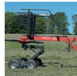
La macchina può essere sollevata idraulicamente fino a 50 cm. da terra.
