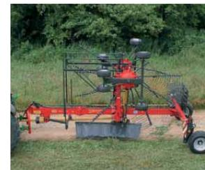
Riduzione altezza di trasporto/ricovero per mezzo di un kit idraulico (opzione) che riduce l'altezza di 30 cm.
