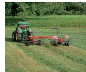
Disimpegno da terra oltre 50 cm, in questo modo è possibile oltrepassare facilmente qualsiasi tipo di andana. Necessario un solo distributore a semplice effetto. Entrambe i modelli possono formare due piccole andane notturne.
