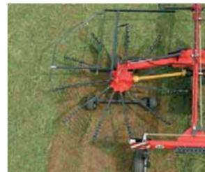
La regolazione della larghezza di lavoro può essere variata da 7 a 7,80 m. meccanicamente o idraulicamente.
