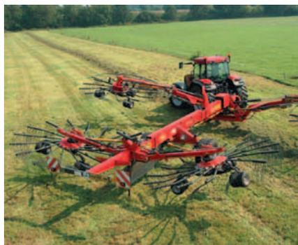
La tête d'attelage pivotante permet des virages serrés.
