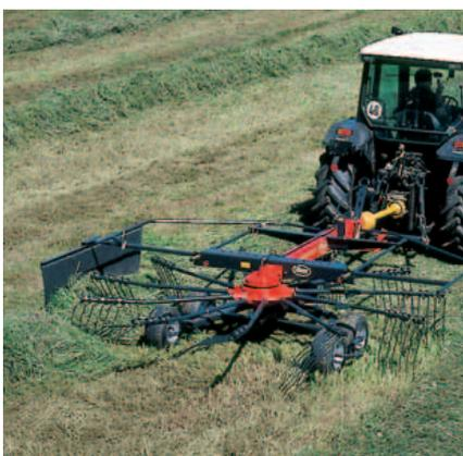
L'Andex 423T est un andaineur trainé avec une largeur de ramassage de 4,20 m. Il est pourvu de 11 bras, d'un tandem, de panneaux de signalisation et éclairage...
