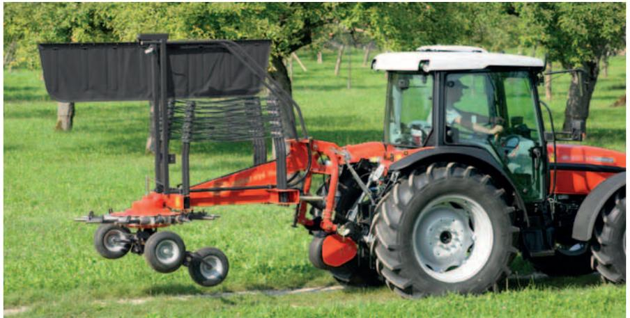
Pour le transport ou le remisage, les garants de protection latéraux se replient le long du châssis. Un ressort d'assistance monté la planche à andain permet de minimiser l'effort au repliage.
