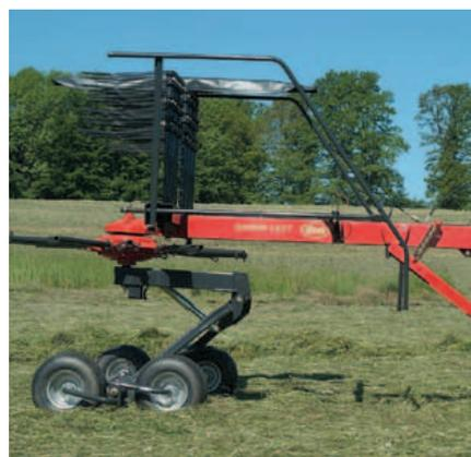
Au transport ou en fourrière, le relevage permet un dégagement important de plus de 50 cm.
