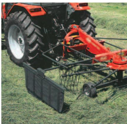
Andex 353: 3,50 m de largeur de travail (version française avec manivelle de réglage de la hauteur de travail et tandem).
