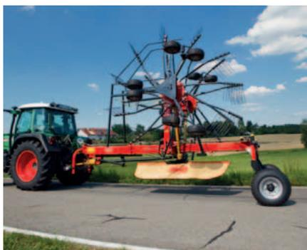
Les andaineurs à andain central se replient hydrauliquement à partir de la cabine. Les bras peuvent être démontés pour encore réduire la hauteur au transport.
