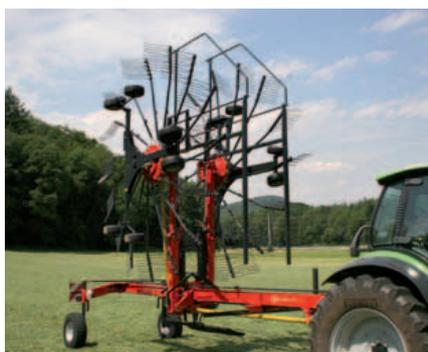
Pour atteindre une hauteur au transport inférieure à quatre mètres les bras peuvent être démontés et positionnés en toute sécurité sur le châssis.
