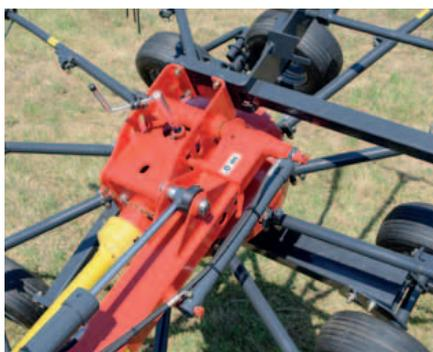
L'ajustement hydraulique des rotors permet un ajustement de la largeur de travail de 7.00 m...
