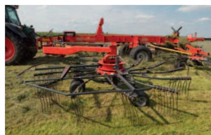
Il est possible de régler hydrauliquement la hauteur de chaque rotor.
