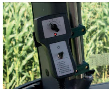
L'andex 1103 est équipé d'un boîtier en cabine permettant de contrôler toutes les fonctions hydrauliques de la machine ainsi que le verrouillage pour le transport.
