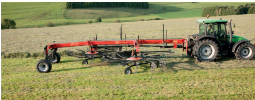
La position basse du châssis arrière permet d'avoir un centre de gravité au plus près de sol pour augmenter la stabilité de l'andaineur.
