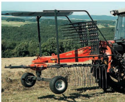
Sur tous nos modèles d'andaineur, il est possible de réduire la largeur au transport en démontant les bras et en les insérant sur les supports fixés au châssis.
