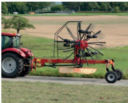
Les Andaineurs à andain central se replient hydrauliquement pour se mettre en position transport.
