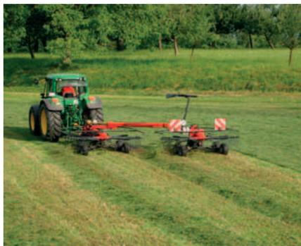
Au transport, la largeur ne dépasse pas 3m (2,45 m si les bras sont démontés). La bache se replie hydrauliquement.
