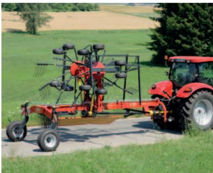
Pour limiter la hauteur de transport, les dents peuvent être démontées.
