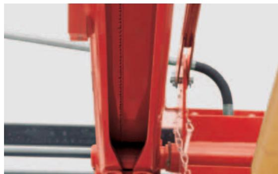
TerraLink Quattro: Les poutres de liaison entre rotors et châssis sont ouvertes pour favoriser une torsion de quelques degrés.
