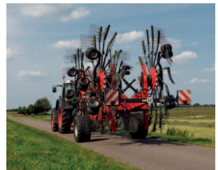
Son système de repliage permet de limiter la hauteur au transport à moins de 4m, sans avoir à démonter les dents.
