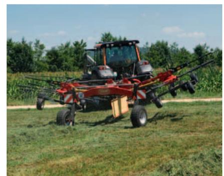
Un ressort assure le relevage et l'abaissement des rotors de façons parallèles, évitant ainsi que les dents se plantent dans le sol durant les manœuvres en bout de champs par exemple.
