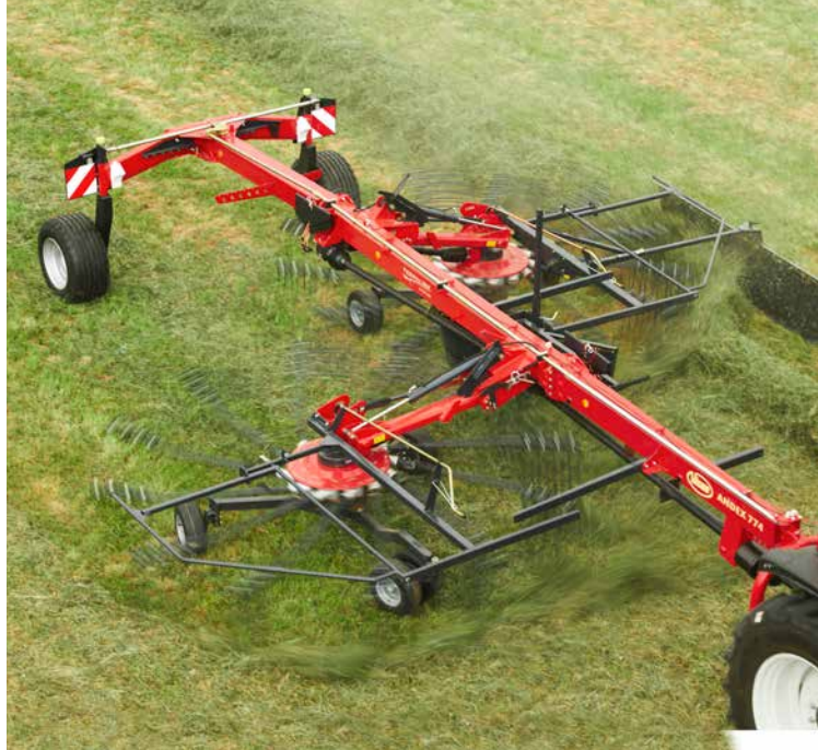
Grote capaciteit, dankzij 13 tandarmen met elk 5 tanden op achterste rotor voor snelle overname.
