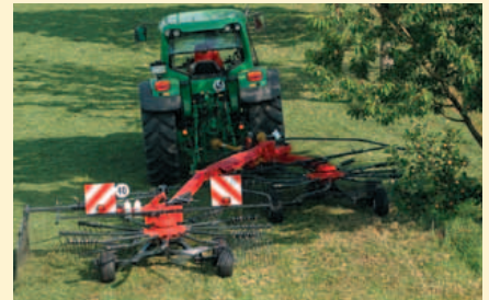
SideShift aan de rechterzijde - comfortabel om langs bomen of sloten te harken.
