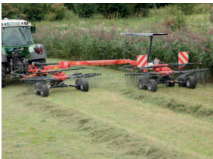
Met de An dex 714 VARIO is het mogelijk om twee zwaden te maken.
