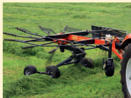
De machine kan heel gemakkelijk tot 50cm uitheffen zonder van de trekker te hoeven afstappen.
