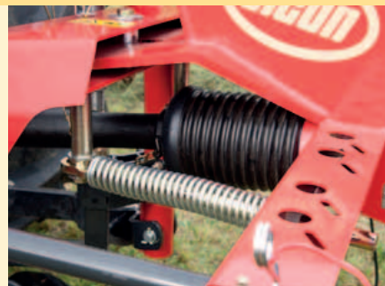
De drie-punts bok heeft een groot zwenkbereik en kan daardoor de trekker optimaal volgen, ook in scherpe bochten. Optioneel kan de machine worden uitgerust met schokdempers.
