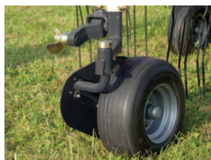
Optioneel kunnen de enkele harken worden voorzien van een derde wiel voor een nog betere bodemvolgving.
