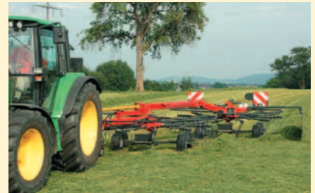
SideShift aan de linkerzijde - de trekker rijdt niet over het gemaaide gras.
