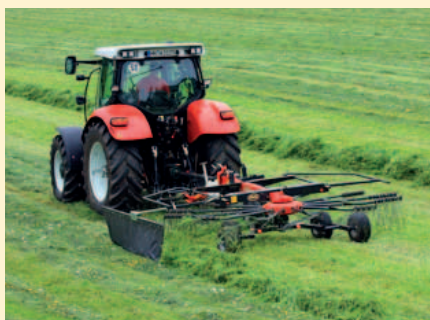
Andex 474T – getrokken 4,70 m brede enkele hark met een gewicht van slechts 665 kg.
