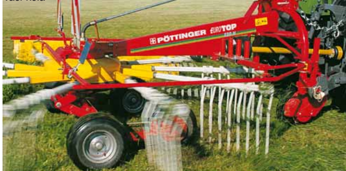
EUROTOP 380 N – multifunkční kopírovací kola
