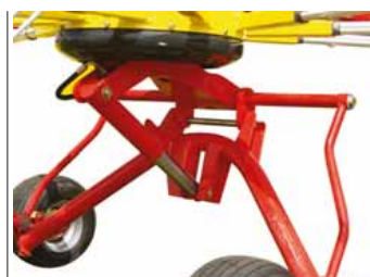
Jednočinné hydraulické zvednutí přes kopírovací kola u modelu 421 A, 461 A, 601 A, 611 A a 691 A
