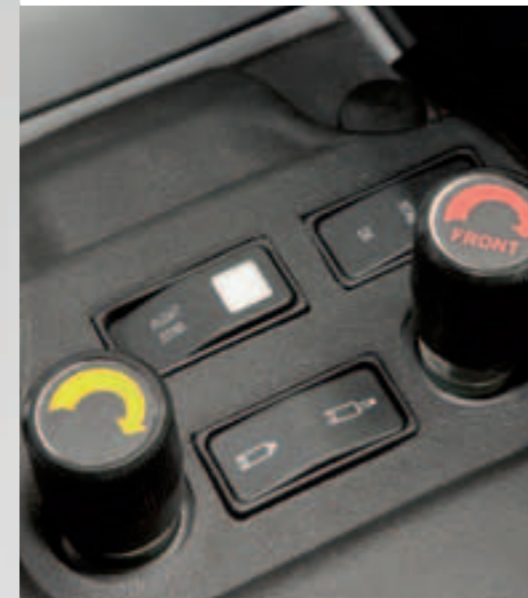
Elektro-hydraulische Seitenstabilisierung und Durchflussmengeneinstellung für Zusatzgeräte.
