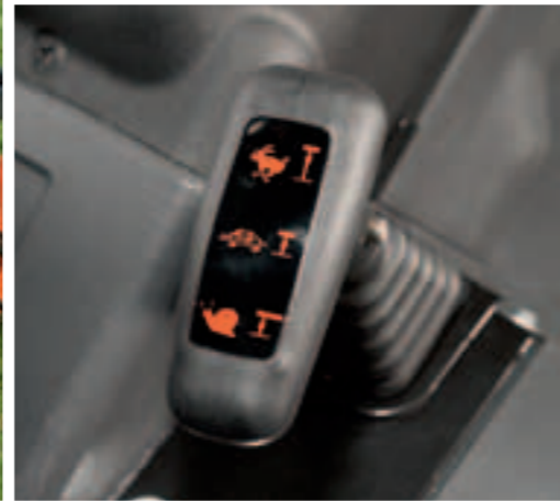
Drei Gruppen stehen für bis zu 45 verschiedene Arbeitsgeschwindigkeiten zur Verfügung.
