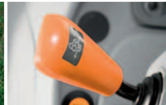
Powershuttle auf Wunsch: Wechsel der Fahrtrichtung einfach und bequem.
