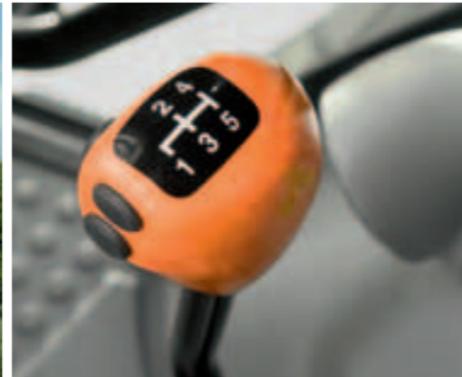
Die Lastschaltstufen werden bequem über Taster im Schaltknopf gewechselt.
