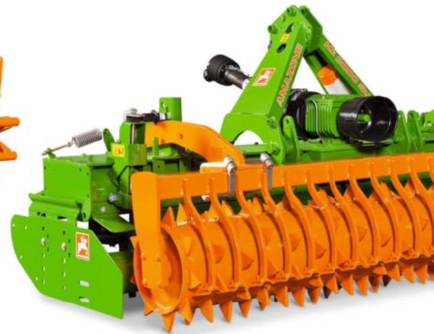
KE 3000 Super con rullo packer; 500 mm
