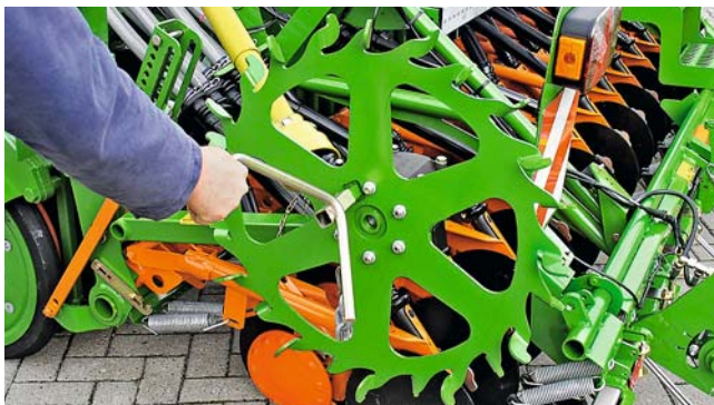
Zkouška výsevku pomocí vaničky
