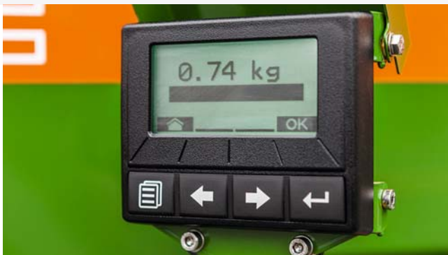
Zkouška výsevku pomocí terminálu TwinTerminal 3.0
