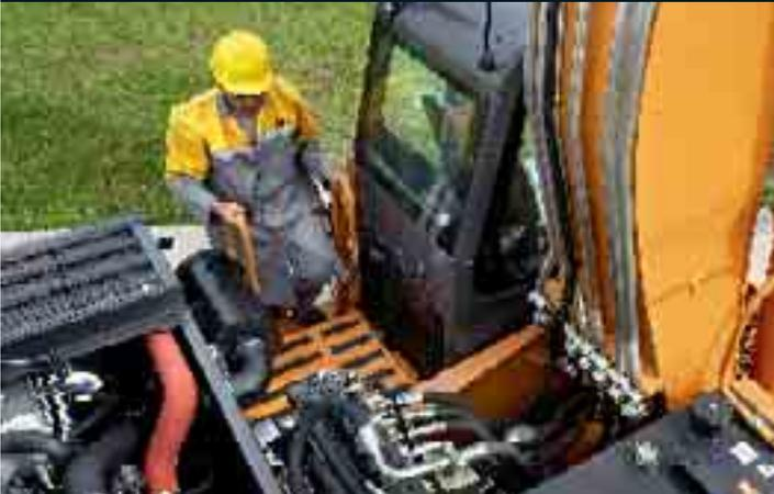
La máquina conserva la pasarela de acceso típica de Case detrás de la cabina. El personal de mantenimiento dispone de un acceso sin precedentes a todos los puntos de servicio y mantenimiento regulares y de un zona de trabajo segura. El acceso a la parte superior del motor, las válvulas hidráulicos y el grupo de refrigeración es sencillo por el gran capó elevable.
