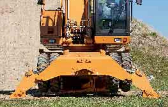
Con el diseño modular del chasis de las WX de Case, los clientes pueden elegir entre estabilizadores, cuchilla niveladora o una combinación de ambos. Los estabilizadores y la cuchilla niveladora se controlan de manera independiente, lo que permite la nivelación de la máquina cuando se trabaja en terrenos irregulares.
