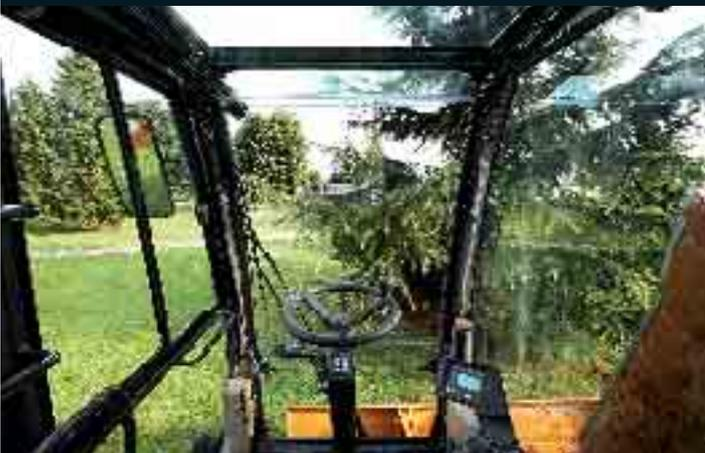
La amplia superficie acristalada con parabrisas de dos piezas y máxima altura ofrece visibilidad de primera clase en torno a toda la máquina. Así el operario dispone de una visión clara del área de trabajo durante las operaciones de excavación y carga, y de la carretera cuando se desplaza de una obra a otra. El bajo capó del motor en la parte posterior de la excavadora garantiza la máxima maniobrabilidad en espacios reducidos.
