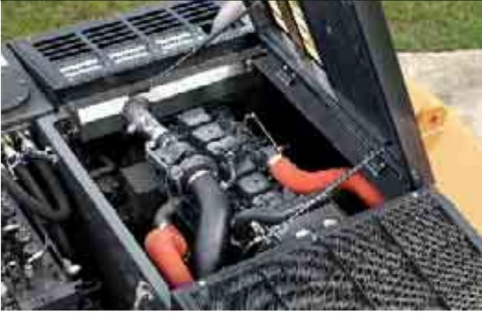
La WX240 está equipada con un motor de seis cilindros Case que ofrece el par máximo y una entrega suave de potencia. Este motor que cumple la normativa de la UE Tier III, con turbocompresor e intercooler, garantiza una combustión más limpia y un mayor rendimiento. Además, se ha diseñado para ofrecer la máxima fiabilidad y durabilidad, y cuenta con una función de precalentamiento automático que asegura una vida útil más prolongada y un tiempo de inmovilización mínimo.
