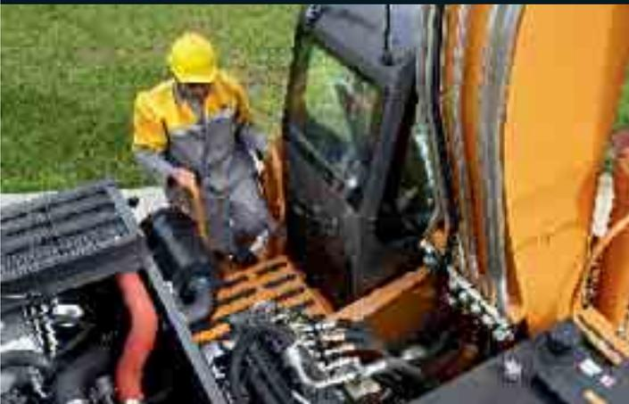
La machine comporte, à l'arrière de la cabine, une passerelle d'accès. Le technicien de maintenance dispose ainsi d'un accès pratique à tous les points d'entretien pour la maintenance journalière et d'un espace de travail sécurisé. La partie supérieure du moteur, le circuit hydraulique et le bloc de refroidissement sont facilement accessibles grâce à un grand capot relevable.
