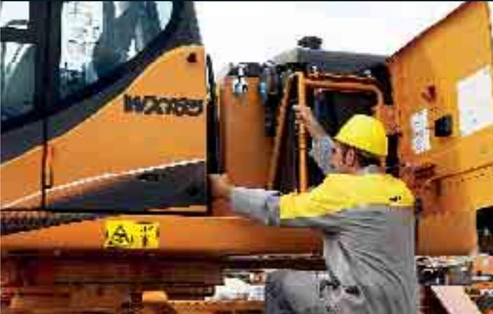
Malgré son faible rayon arrière, la WX Case comporte, à l'arrière de la cabine, une passerelle d'accès Case. Celle-ci permet au technicien de maintenance d'accéder aisément aux points d'entretien et de maintenance quotidiens et constitue une zone de travail sûre. Le capot relevable du moteur offre une vue dégagée sur la partie supérieure du moteur, les distributeurs hydrauliques et le bloc de refroidissement.
