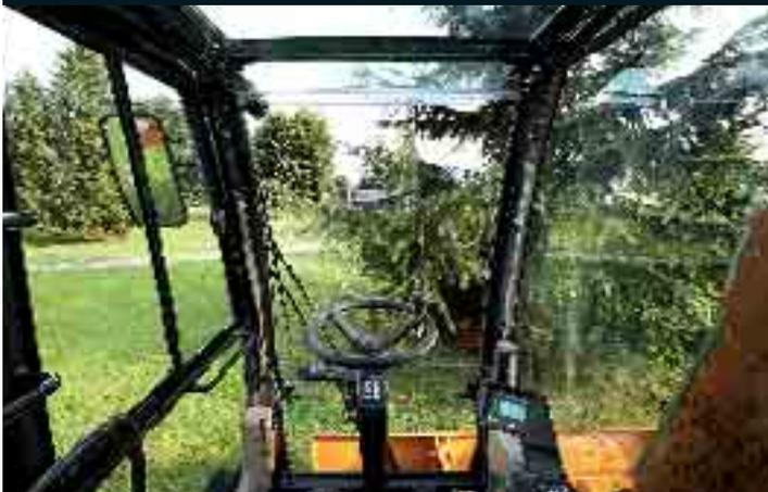
La grande surface vitrée du pare-brise pleine hauteur en deux parties procure une visibilité panoramique inégalée. Le conducteur profite d'une vue dégagée sur le chantier lors du creusement et du chargement, ainsi que sur la route lors des déplacements entre chantiers. Le capot surbaissé du moteur à l'arrière de la machine offre une vue dégagée sur l'arrière de la pelle lors des manœuvres en terrain confiné.
