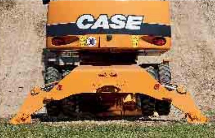
Les clients peuvent équiper leurs machines de stabilisateurs, d'une lame ou d'une combinaison des deux grâce à la conception modulaire du châssis WX Case. Les stabilisateurs et la lame de remblayage sont dotés de commandes indépendantes pour permettre le nivellement sur les surfaces irrégulières.
