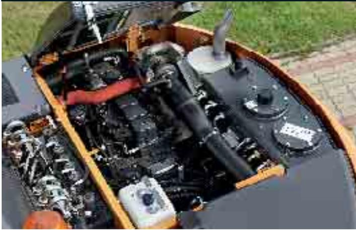
La WX185 est équipée d'un moteur Case à six cylindres procurant un couple maximum et une puissance tout en souplesse. Conforme à la norme européenne Tier III, ce moteur turbo à refroidissement intermédiaire est conçu pour assurer une combustion propre optimale et un rendement élevé. Sa conception lui garantit une fiabilité et une robustesse maximale ainsi qu'une immobilisation réduite au minimum.
