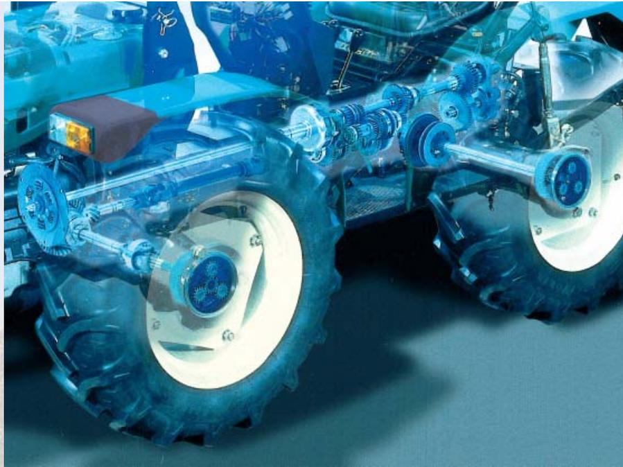
Die vordere und hintere Differential Sperre ist nach Wunsch mechanisch oder elektro-hydraulisch betätigt.
