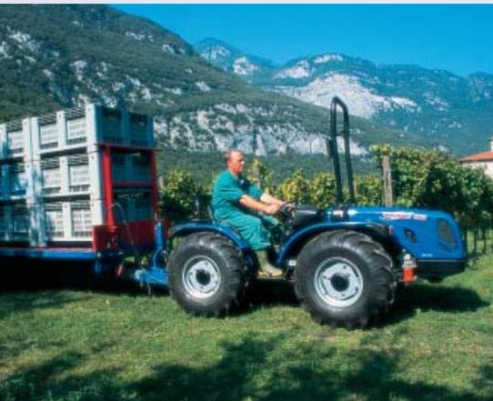
Der VALIANT ist in der konventionellen "Mono-direktional" Version und in der Ausführung mit Rückfahreinrichtung lieferbar. Diese Rückfahreinrichtung vergrößert die Anwendungsvielfalt der Traktoren. In nur 5 Sekunden kann der gesamte Fahrerstand (Sitz, Lenkung und Armaturenbrett) um 180° gedreht werden.
