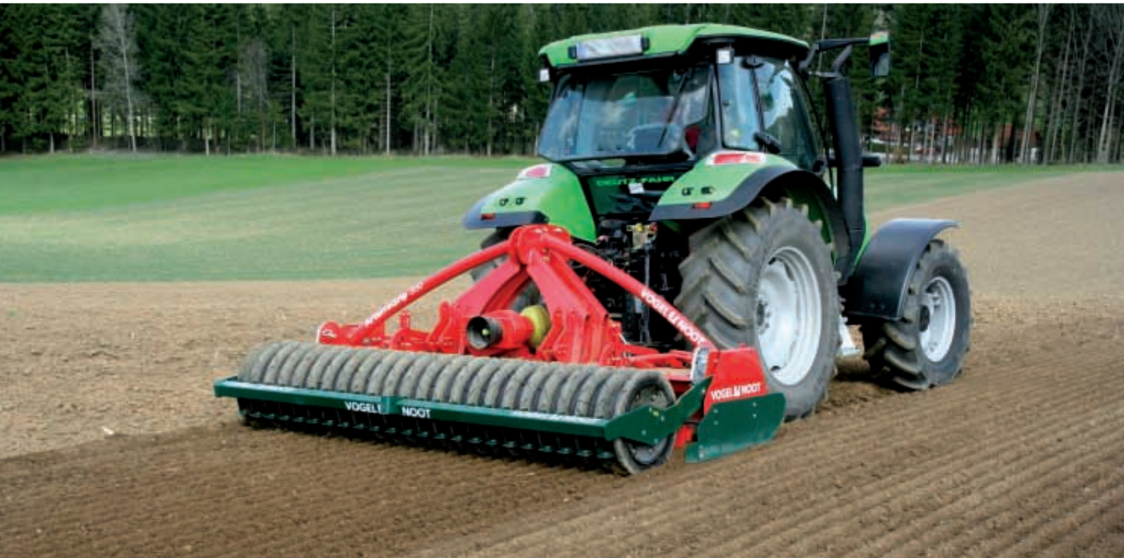
ArterraGrip 300 mit Gummi-Keilringwalze
