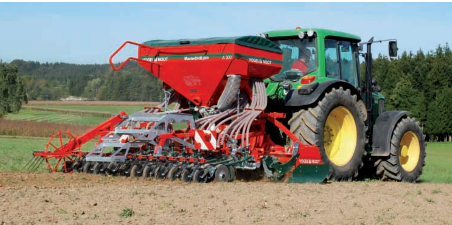
ArterraGrip 300 bei der Mulchsaat mit MasterDrill pro Sämaschine
