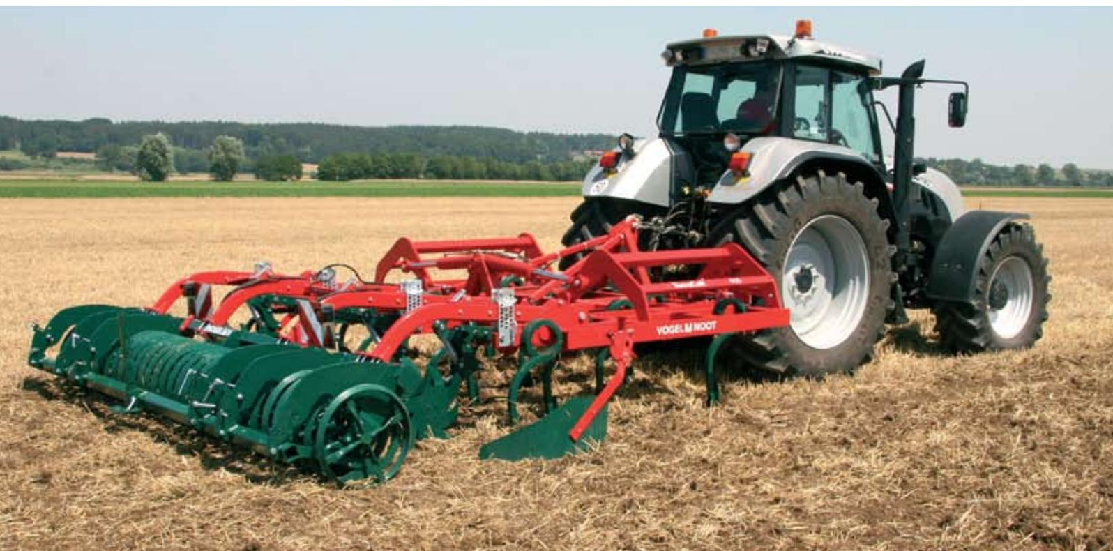
TerraCult 400 repliable avec dents à ressort à spirale de série et rouleau Terrapak
