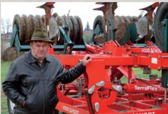
M. Vági travaille principalement sur des sols légers et sablonneux. Sur ce type de sol, le TerraFlex 500 Hydro avec TerraLift M équipé du rouleau sillonneur Caoutchouc ø 500 mm garantit un travail parfait et un excellent rappui. Selon M. Imre Vági, le rouleau sillonneur Caoutchouc fonctionne très bien sur tous les types de sol et ainsi il ne risque pas de bourrer même lorsque le sol est légèrement humide. Le déchaumeur à dents est attelé à un tracteur John Deere de 250 PS.
