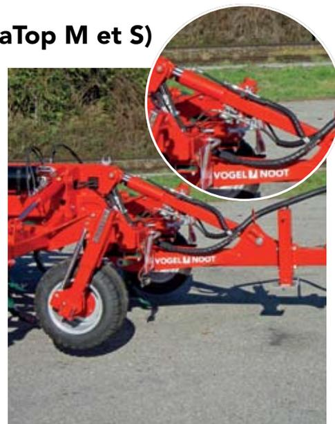
**Commande hydraulique de la flèche :**
