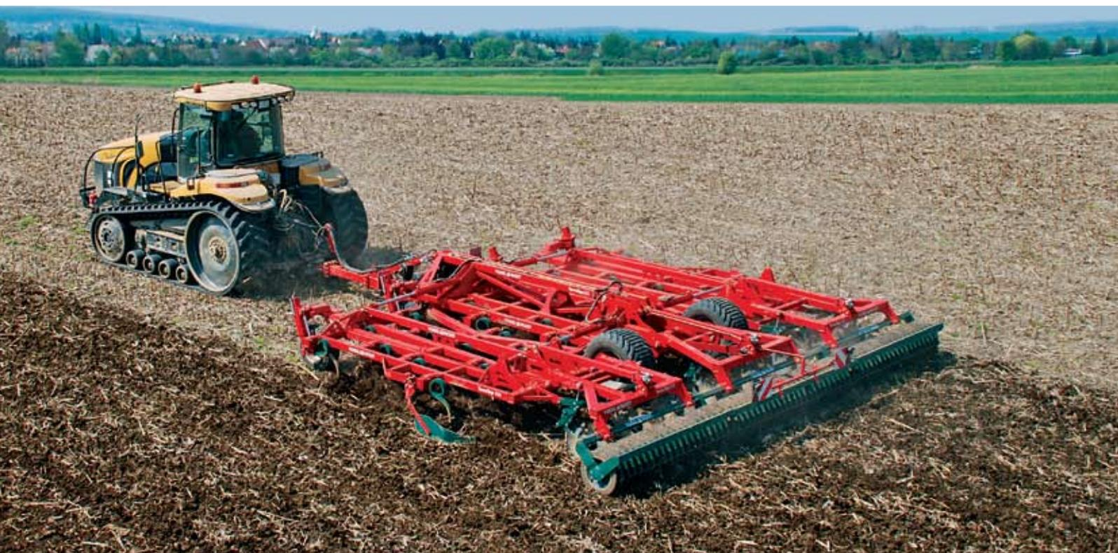
TerraTop S 800 avec dents queue de cochon de série et rouleau sillonneur Caoutchouc
