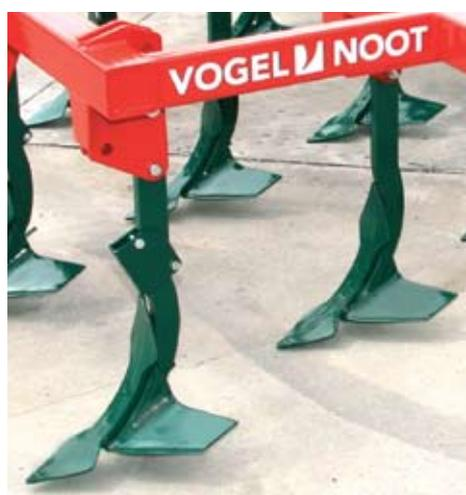
Cette combinaison est aussi bien adaptée au travail en profondeur moyenne de sols lourds que pour la préparation de lits de semence en couverture. L'angle d'attaque réglable du soc à ailettes garantit la meilleure pénétration possible dans les sols durs. Les tôles de guidage placées sur les dents de la première rangée améliorent le flux de la terre.
