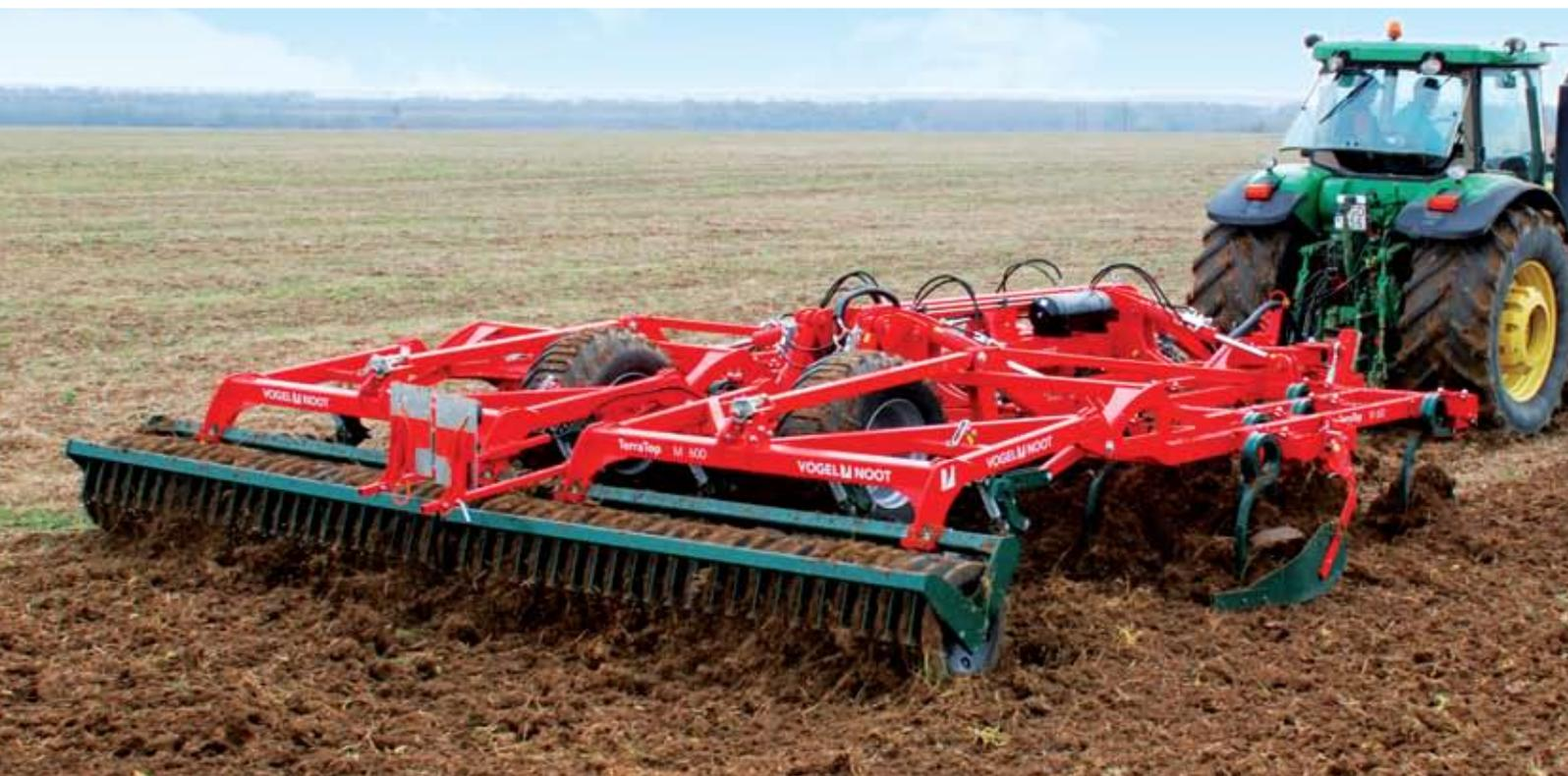
TerraTop M 600 avec dents queue de cochon de série et rouleau sillonneur Caoutchouc
