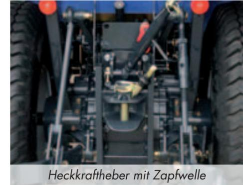
Heckkraftheber mit Zapfwelle
