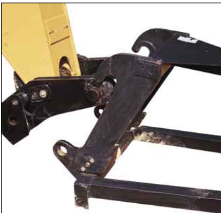
Schnellwechsler in das aufzunehmende Arbeitsgerät einführen
