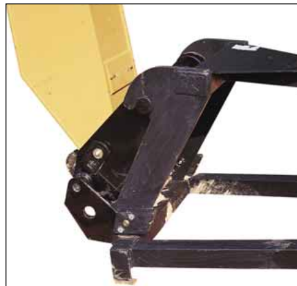
Schnellwechsler nach hinten neigen
