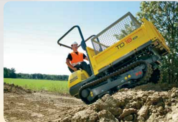
La benne basculant en trois directions, au format des palettes européennes, élargit considérablement les domaines d'application du TD18. Elle en fait un spécialiste des missions de transport en terrains difficiles.
