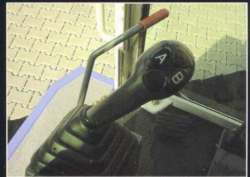
**Z**usatzhydraulik über Joystick zu bedienen (A+B)
