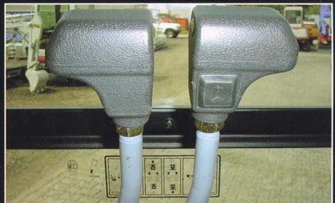
**Z**weite Fahrstufe im Fahrhebel zuschaltbar
