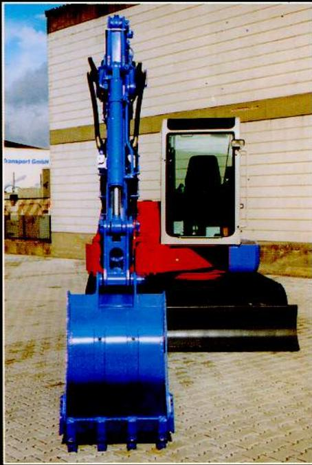
Seitlicher Versatzausleger für paralleles Schichten an Hauswänden ohne überstehende Heck- und Seitenteile der Maschine
