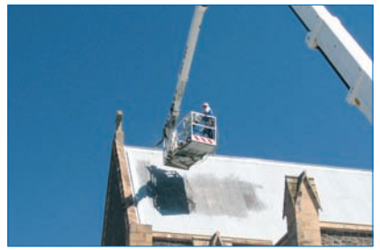
Rotation du panier sur 90°. Extension hydraulique disponible comme option.
