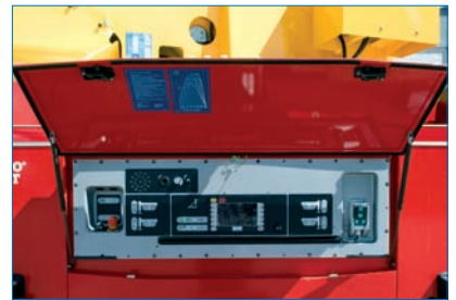
Mise en place des béquilles de façon automatique (poussoir).
