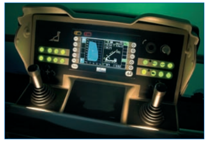
Tous les unités XDT ont le système de contrôle électronique Bronto+ avec displays en couleur à visibilité extraordinaire.
