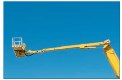
Pendulaire télescopique qui donne un déport supérieur.
