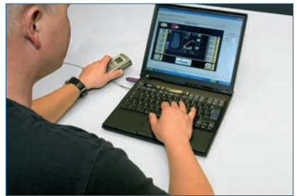
Le système de contrôle Bronto permet de passer des informations diagnostics entre l'élévateur et le service clients Bronto. La détection d'erreurs et la manutention peuvent être faites en ligne.
