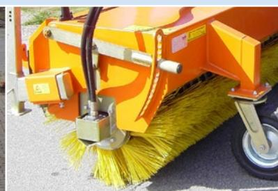
Zwei leistungsstarke, innenliegende Motoren für den Bürstenantrieb
