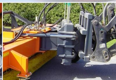
Optimale Boden Anpassung durch robusten 3D-Niveausgleich
