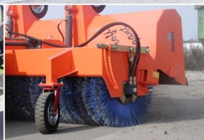
Einfache Bürstennachstellung über Rasthebelsystem
