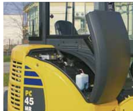
Cofano anteriore: accesso al serbatoio carburante
