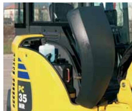
Cofano anteriore: accesso al serbatoio carburante
