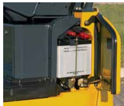
Cofano sinistro: accesso alla batteria
