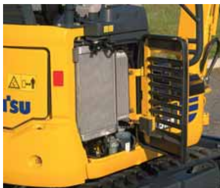
Cofano destro: ispezione e pulizia dei radiatori
