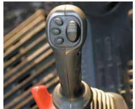
Joysticks mit Proportionalsteuerung für Anbaugeräte
