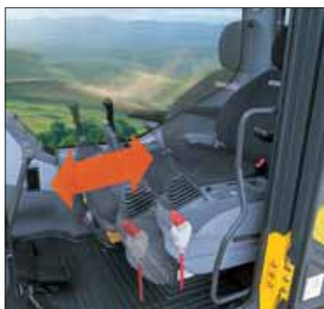
Lunga corsa del sedile: 340 mm
