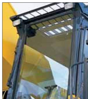
Tergicristallo montato sul montante cabina
