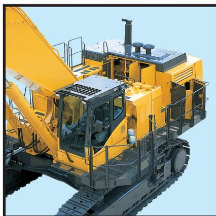
**Große Wartungstüren** erleichtern den Zugang zum Motor. (Das Foto zeigt den Motor von vorn bei geöffneter Seitentür).
