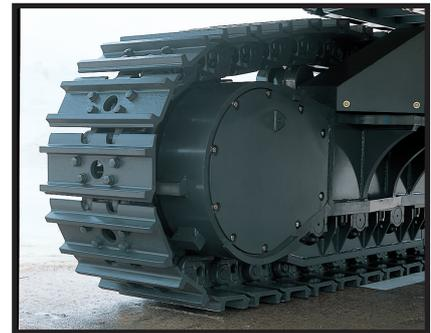
**Robuste Schutzvorrichtungen** für die Fahrmotoren gegen Beschädigung durch Felsgestein.
