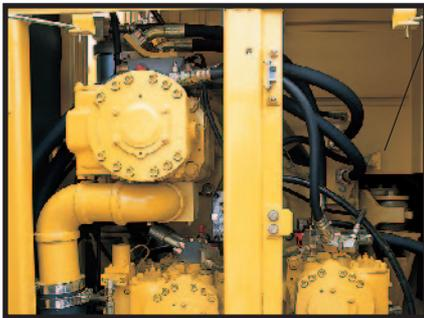
Die **Pumpen-/Motorraumtrennung** bietet Schutz vor Ölspritzern, die bei einem geplatzten Hydraulikschlauch auf den betriebsheißen Motor gelangen könnten.
