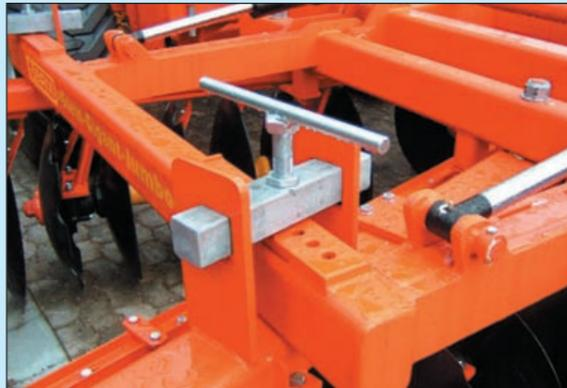
Die Einstellung der Segmente wird werkzeuglos vorgenommen. In 9 Stufen kann der Schnittwinkel verstellt werden. Einfachste Handhabung sorgt für problemlose Einstellung der Geräte.
