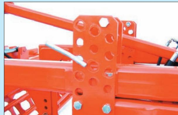
Die Einstellung der Arbeitstiefe erfolgt bei der "Leader" über eine Lochschiene mittels Absteckbolzen. Die Transporträder laufen bei der Arbeit frei.
