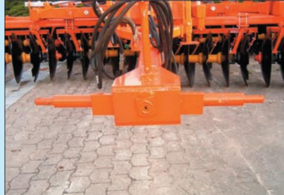
Die Scheibenegge wird mittels pendelnder Tragachse Kat. III in die Unterlenker des Schleppers eingehängt. Auf dem Vorgewände kann somit relativ kurz gedreht werden.
