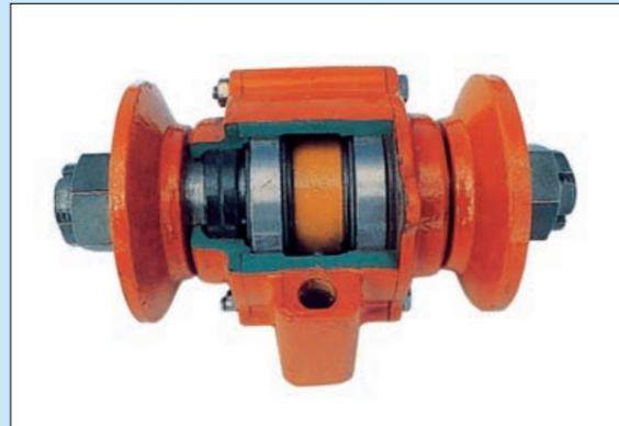
Das vollkommen geschlossene Gehäuse ist aus Kugelgraphitguß. Durch perfekte Abdichtung vollkommen staubgeschützt. Eine Schmierung ist nur alle 500 ha erforderlich.
