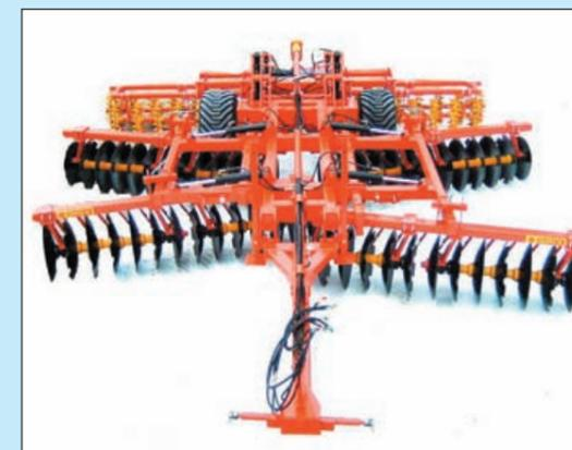
Der Hauptrahmen der "Stein-Gigant" MAGNUM Scheibenegge wird aus Material 200 x 120 mm gefertigt. Alle Bauteile wie Bolzen und Zylinder wurden überdimensioniert ausgelegt, so daß das Gerät auch unter schwersten Bedingungen und höchsten Flächenleistungen störungsfrei arbeitet. Bedingt durch das hohe Eigengewicht der MAGNUM, ist selbst auf schwerem, trockenem Boden ein Eindringen in die Erde gewährleistet.
