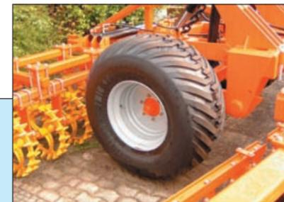
Die große Bereifung 550/60-22.5 sorgt für sicheren Transport.
