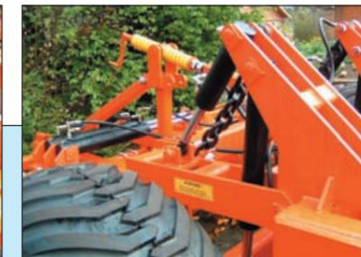
Hydraulische Tiefenregulierung über Nachlaufwalze.
