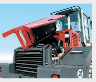
Hohe Verfügbarkeit ist eine Voraussetzung für rentables Arbeiten. Dieser O&K-Lader ist deshalb bis ins Detail auf kurze und einfache Wartung konzipiert. Vorbildliche Zugänglichkeit zu allen Wartungsstellen, lange Wartungsintervalle, verbunden mit einem elektronischen Kontrollsystem, halten den L 35.5 dauerhaft einsatzbereit.
