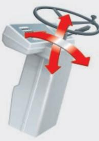
Leichter Ein- und Ausstieg und stets optimale Sitzposition durch die verstellbare Lenksäule
