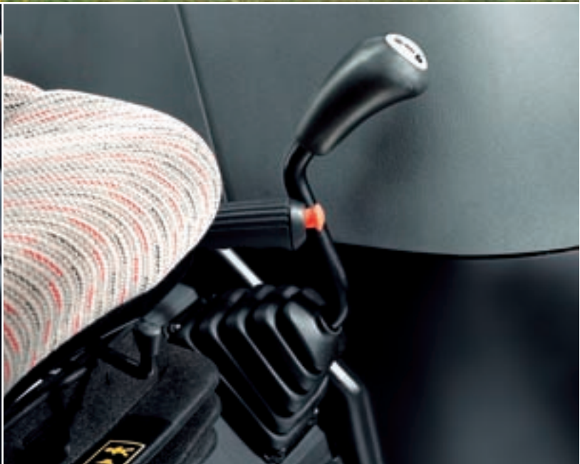
Auf den Modellen mit Synchrongetriebe ist der Shuttle-Hebel V/R links neben dem Fahrersitz.
