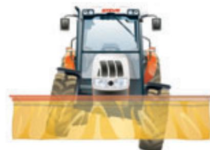
**Moderne Details am Frontkraftheber.** Die EFH gestattet den Auflagedruck des Frontmäherwerks bequem von der Kabine aus feinstufig einzustellen und jederzeit nachzuregulieren. Es beansprucht in der Folge weniger Schubkraft und Motorleistung. Es schont die Grasnarbe und erhöht die Qualität.
