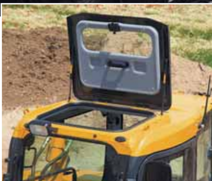
Aufklappbare Dachluke für optimale Sicht nach oben
