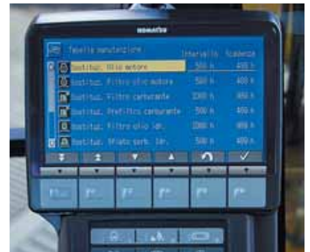
Der LCD-Monitor zeigt Unregelmäßigkeiten und Wartungsintervalle an
