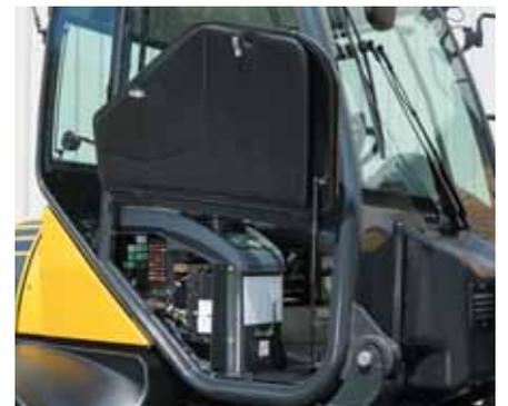
*Seitliche Wartungsklappe für schnellen Wartungszugang*
