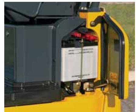
Linke Wartungsklappe: leichter Zugang zur Batterie
