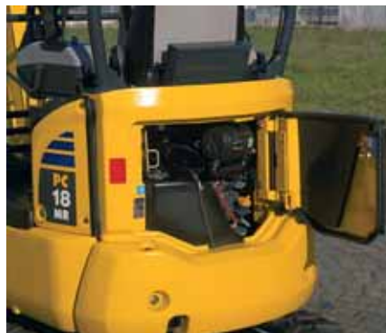
Hintere Wartungsklappe: schnelle Motorinspektion und Betankung
