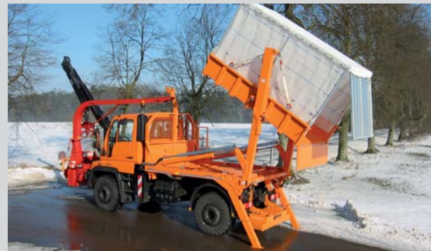
Ein CombiCon mit Gitterbox-Behälter zur Aufnahme von Häckselgut, hier in Hochauskipfung.
