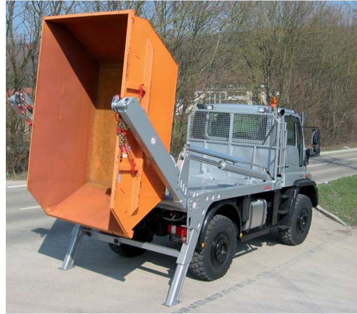
Der CombiCon mit gekipptem DIN-Behälter.
