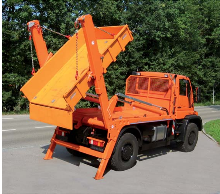
Der CombiCon mit einem Flachcontainer bei der Hochauskipfung.
