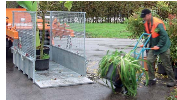
Pflanzen, Sträucher oder verschiedene andere Transportgüter werden ebenerdig geladen und in der Waagrechten aufgenommen.
