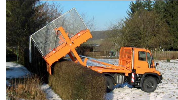
Sand, Kies, Humus, Mulch, Garten- und Pflanzenabfälle können über Hindernisse hydraulisch hoch ausgekippt werden.
