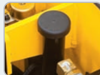
Apertura serbatoio olio
