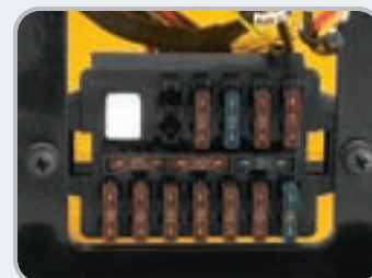
Boîte à fusibles centralisée pour une inspection aisée
