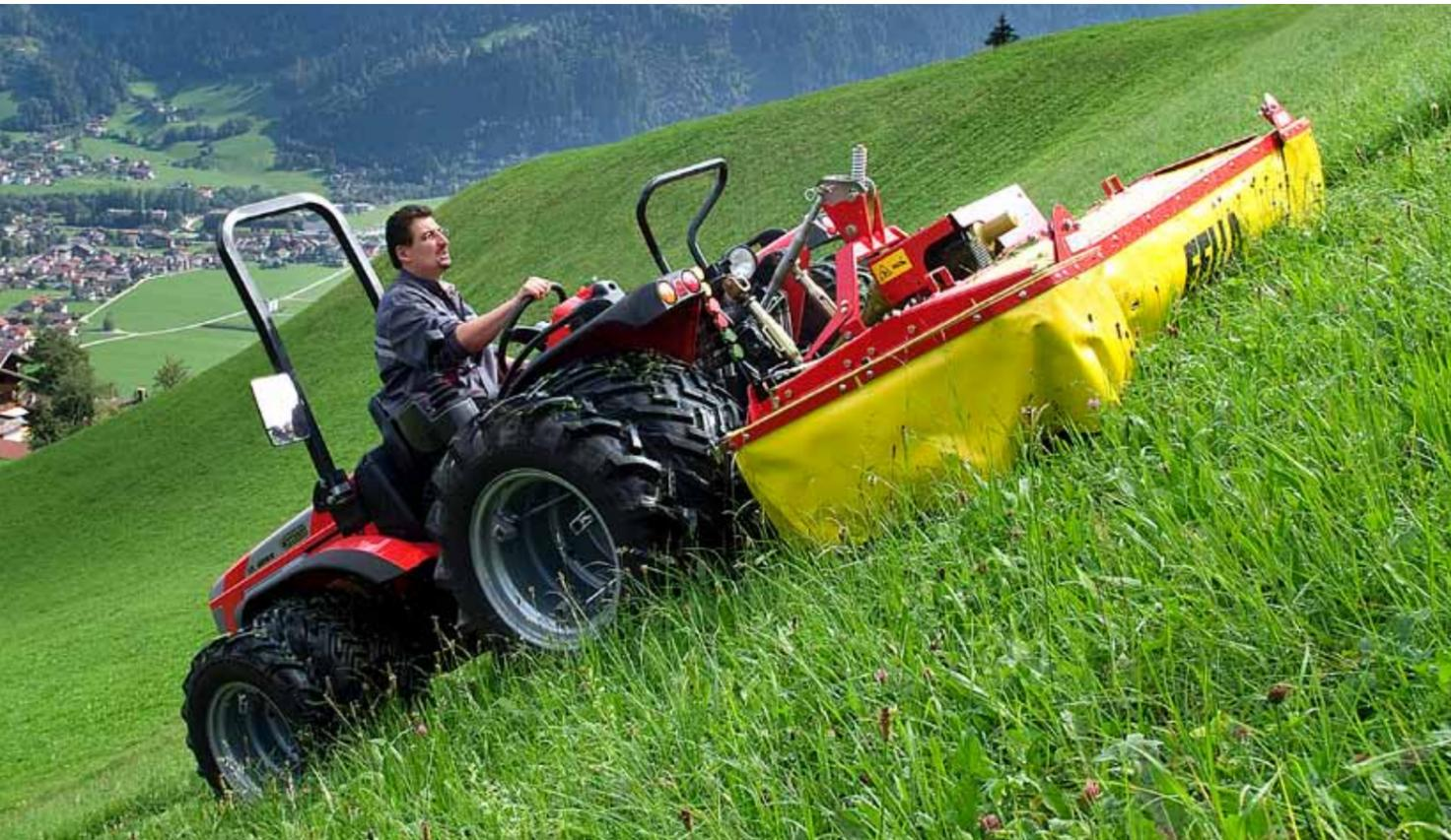
La **trasmissione idrostatica**, conferisce ineguagliabile praticità operativa negli andirivieni in sequenza rapida. Con la leva **invertitore di direzione** è possibile cambiare senso di marcia con la massima facilità e rapidità. E' dotata del dispositivo **"Speed-Fix"**, un autentico specialista in caso di lavorazioni che richiedano velocità d'avanzamento costante.
